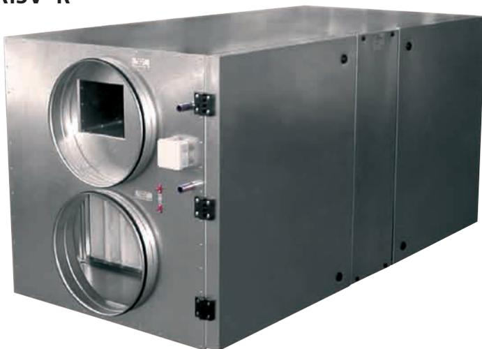
Установки с рекуперацией тепла RISV-R очищают, нагревают и подают свежий воздух. RISV-R устройства извлекают тепло из выходящего воздуха и передают его в поступающий.
